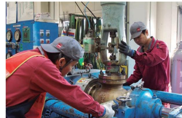
完成整備的阀门使用专用试验机进行各种功能检查。(耐压、机密试验/泄漏试验/运转试验等)
