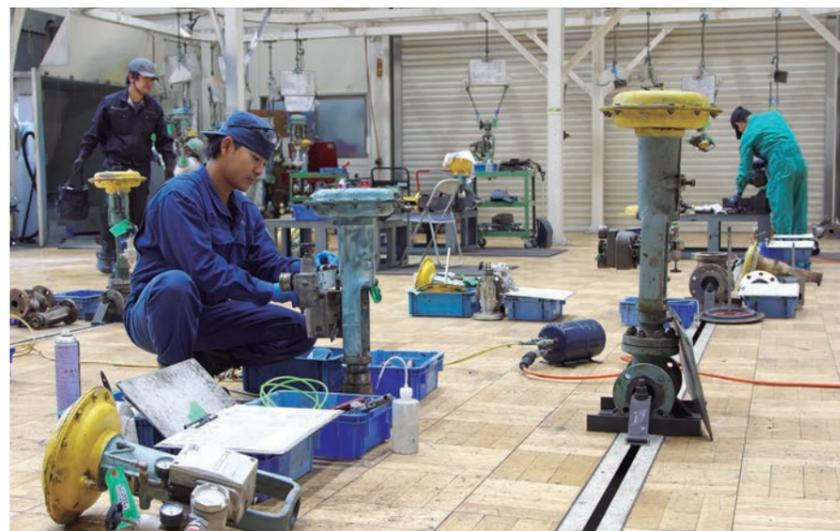
为了在进行作业时保持阀门(中心)的稳定，将阀门固定在整備用轨道上进行检查。将整備用轨道从2根增至4根，确保了整備效率高的作业活动线。
