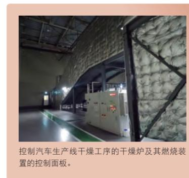
控制汽车生产线干燥工序的干燥炉及其燃烧装置的控制面板。
