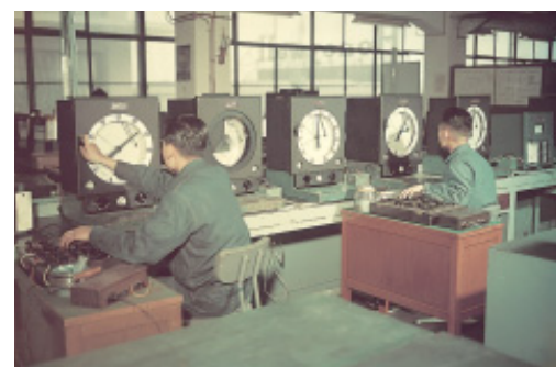
電子管式計器の調整作業 (蒲田工場)
