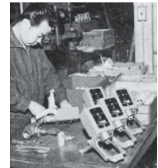
モジュトロールモータの組み立て作業 (蒲田工場)
