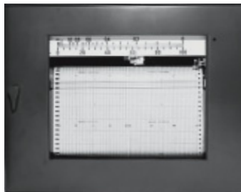
電子管計器153型 (打点指示記録計)
