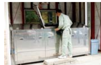
バイオ式環境貢献型生ごみ処理機は専用の建屋の中に設置されています
