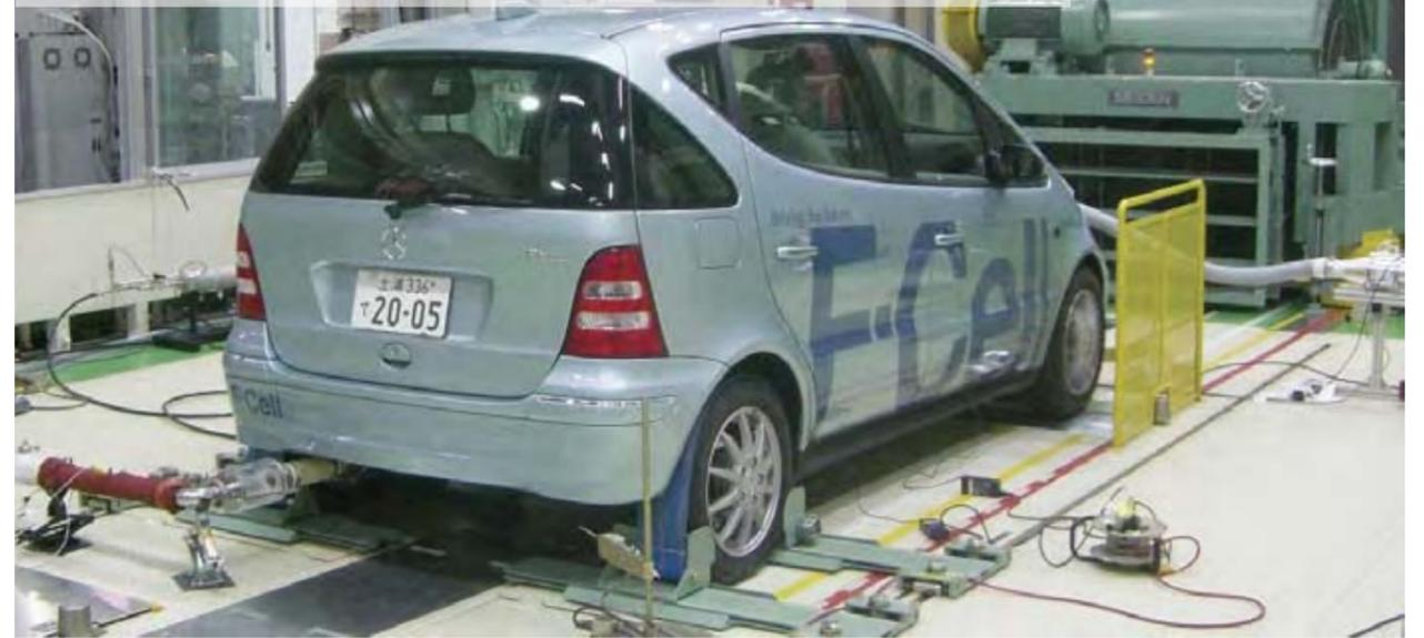
燃費計測は、実験車をローラーの上で走行させて行います（写真提供：財団法人日本自動車研究所）
