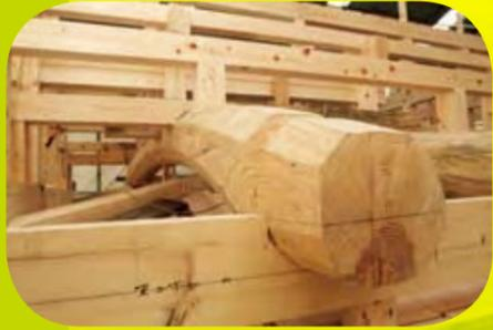
粘りがあるマツは屋根の荷重を支える梁に使われる。木の特性を適材適所に生かす
