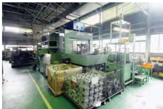
アルミ部材を加工するマシニングセンター
