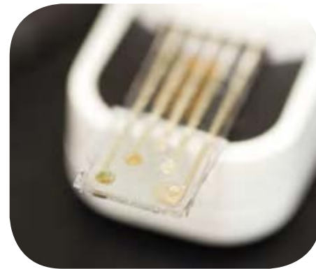
■ポータブルテイスセンサ 現在開発段階の小型の味覚センサ。極小化したセンサの数は5本で、それぞれが甘味、酸味などの5つの味覚に対応する
