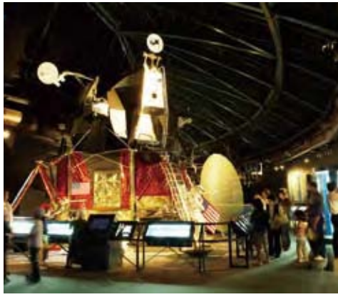
アポロ月面着陸船LM(アメリカ)。土台部分で光っているのは、熱を反射させるためのシート
