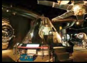
アポロ司令船CM（アメリカ）。ステンレスのボディを耐熱コーティングしている
