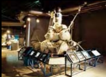
ルナ24号月面着陸船（旧ソ連）。地球に帰還するのは、最上部の黒い球体のみ
