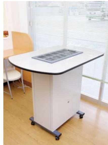
吸引した空気は、プレフィルタと電気集じんセルを通過し、汚れた粒子が集じんされる。その後、活性炭フィルタを通過して、きれいな空気となって再び排出される ※本製品は、粒子状の粉じんは除去しますが、CO等のガス成分は除去しません。必ず換気は行ってください
