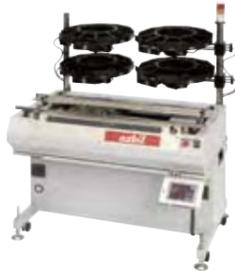
株式会社 山武商會の作造くんは、プリント基板のリード部品実装をサポートする挿入補助装置です。「作造くん」は作業者に挿入部品と挿入位置を指示します。作業者はプリント基板のスルーホールに指示された部品を挿入しボタンを押すだけで、作造くんがリードのカットとクリンチを実行します。慣れない人でも自分のペースで実装作業を習得できます。本製品は、各種自動組立機で豊富な実績を誇る山
