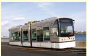
川崎重工で開発中の超低床電池駆動 LRV「SWIMO」
