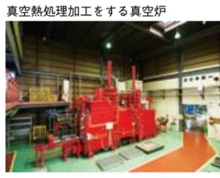
真空熱処理加工をする真空炉
