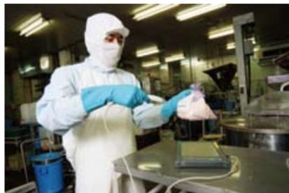
サラダ加工は袋の管理ラベルを読み込んでから原材料を投入。投入工程などの製造現場では画面の大きいタブレットPCが使われている
