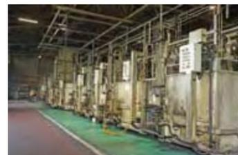
トランスファーマシン。マシニングセンターを組み合わせて金属部品を自動搬送し、ラインを1周することで一つの部品加工が完成する
