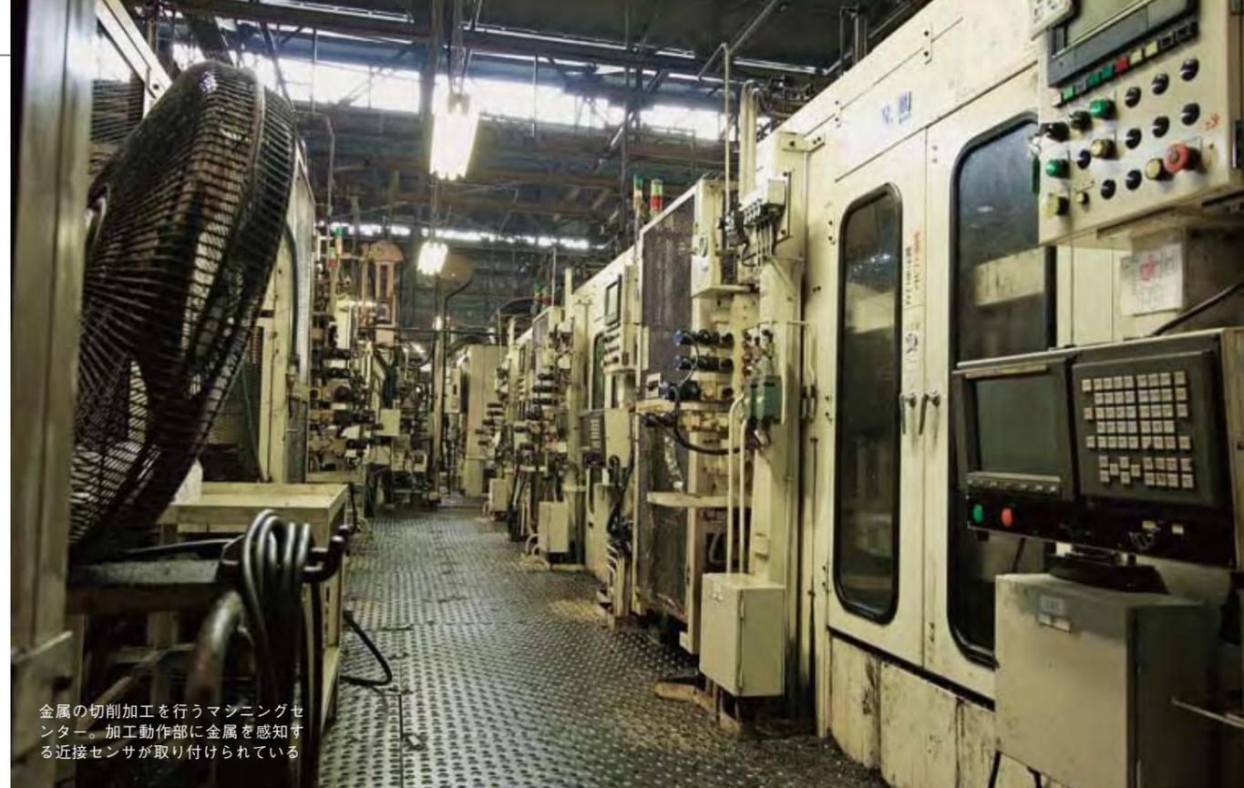
金属の切削加工を行うマシニングセンター。加工動作部に金属を検知する近接センサが取り付けられている
