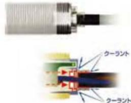
耐環境形近接センサ FL7M-Cシリーズ。ケーブルの材質は耐油性の高いポリウレタン。コネクタ部分にはクーラントの浸水に対する徹底した対策を施した
