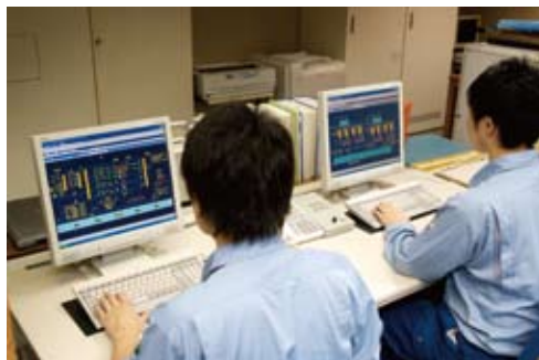
BEMS装置として、空調、熱源、衛生の設備を管理し、ビル内の情報を一元管理するsavic-net FX
