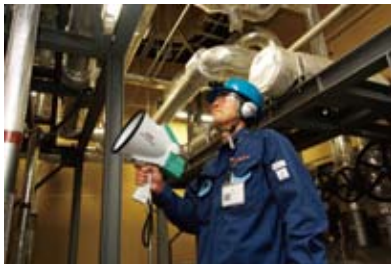
気体が配管などから漏れる時に発する超音波を検知するリークディテクターⅡ
