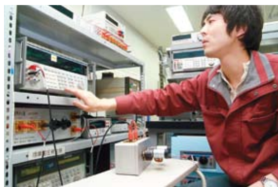
＜電気関連標準器（標準電圧発生器や標準抵抗器など）＞ 0.1ppm（100万分の0.1）の数値を測定する。
