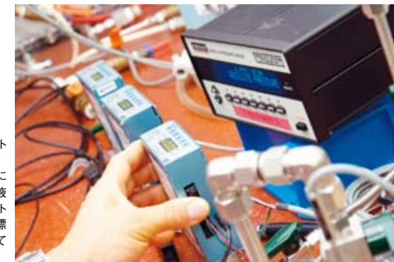
＜マスフローコントローラの校正＞ 液体の量を正確に量るために、その液体をガス化してコントローラの出力値と標準器の値を比較して校正している。
