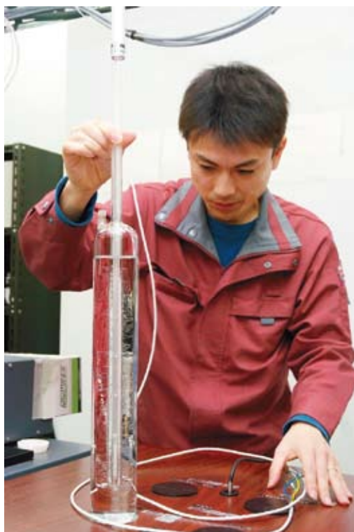
＜温度標準器（水の三重点実現装置）＞ 水・氷・水蒸気が同時に存在する環境をつくり、温度の基準点を実現する。
