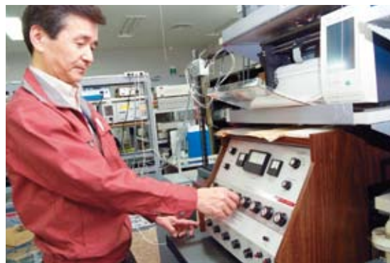
＜温度標準器（温度測定用ブリッジ）＞ ±0.0001℃で温度を測定している。
