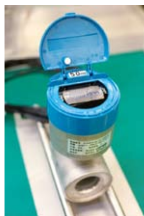
電池式電磁流量計。リチウム電池で8年間、動作する。配線が不要でポータビリティに優れるなど、電磁流量計の市場を新たな分野に広げる画期的な製品。
