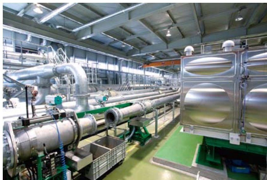
実流校正装置。校正する電磁流量計を配管にセットし、一定流量の水を流す。電磁流量計が計測した値と、流れてきた水の重量を計測した値を比較(秤量法)し、校正を行う。
