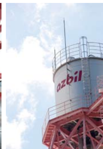
安定した流量を実現するために、オーバーフロー式の高架水槽(高さ35m)から水を落下させて計測を行う。
