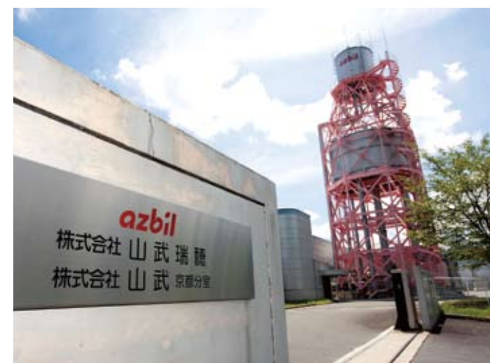
2008年12月に完成した国内最大規模の実流校正装置(高架水槽)。
