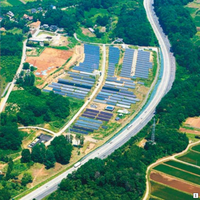
① NEDO技術開発機構委託事業 大規模電力供給用太陽光発電システム安定化等実証研究。山梨県北杜市にある2メガワット級のメガソーラー実証研究施設。 ② コンクリート基礎を用いない経済性、環境性を考慮した太陽電池パネル設置架台。 ③ 施設内にある道路に遮られず動物が通り抜けできるトンネル「アニマル・パス・ウェイ」。
