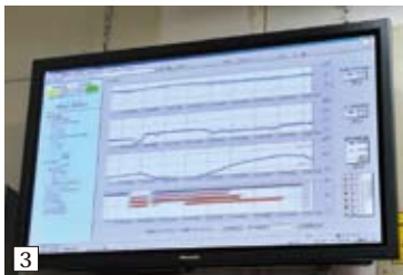
1 動力室に設置されたU-OPTの監視制御端末。 2 並べて設置されているHarmonasとEneSCOPEの監視端末。エネルギーの使用状況を確認しながら、設備の運転状況も把握できる。 3 動力室内の大型ディスプレイにはU-OPTやEneSCOPE、Harmonasの画面を表示することができ、運転員間での情報共有を行っている。
