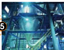
ドライヤーのような巨大な乾燥機を使って水分を飛ばしていく。
