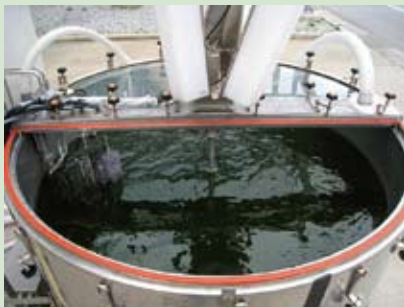
7日後、ミドリムシは大量に増殖。排出ガスを通気した方が、空気を通気するよりも増殖が速い上、ミドリムシ以外の生物の増殖が抑えられることが確認された。
