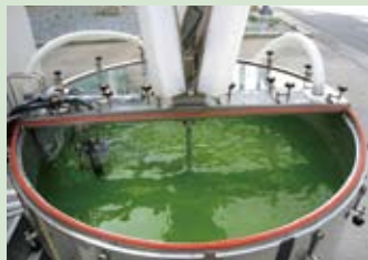
石炭火力発電所からの排出ガスをミドリムシの培養プールに通す。
