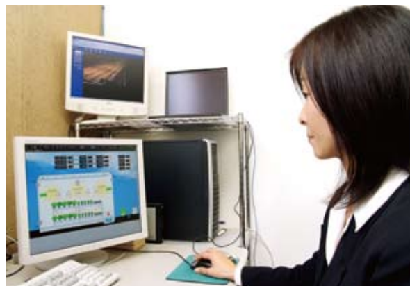
事務所に設置された植物工場用の中央監視システム。ここから実験棟内の様子をはじめ温度、湿度などの状態を随時監視、閲覧できるようになっている。
