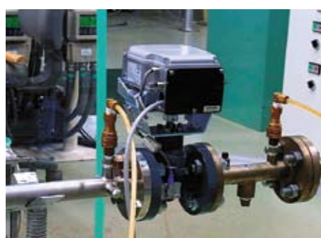
性能試験を行う流量計測制御機能付電動二方弁 ACTIVAL。
