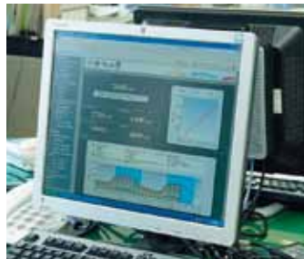
学生や教職員だけがアクセスできる学内専用ネットワークで提供される電力使用量を“見える化”した画面。学部や研究科ごとに表示する。現在の電力使用量や1時間分の積算電力グラフなどを確認できる。
