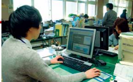
学生や教職員だけがアクセスできる学内専用ネットワークで提供される電力使用量を“見える化”した画面。学部や研究科ごとに表示する。現在の電力使用量や1時間分の積算電力グラフなどを確認できる。
