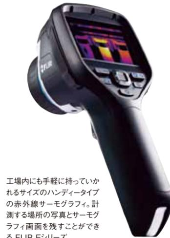
工場内にも手軽に持っていかれるサイズのハンディータイプの赤外線サーモグラフィ。計測する場所の写真とサーモグラフィ画面を残すことができる FLIR Eシリーズ。
