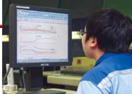
運転室にあるPREXION。操炉データの長期にわたる蓄積が可能となり、様々な角度からのデータ分析を行うことで運転の改善を図るとともに、設備トラブルの原因究明にも役立っている。同じ端末が整備、技術などの部門にも設置されており、逐次、操炉の様子を確認することができる。
