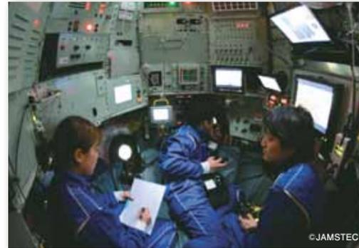
内径2mのコックピット内には様々な機器が設置され、2人のパイロットと1人の研究者が乗船する。厚さ138mmの三つあるメタクリル樹脂製ののぞき窓から外部を観察できる。
