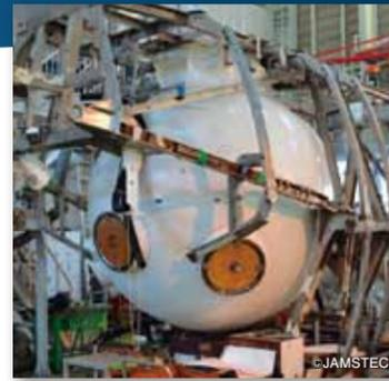
コックピットは内径2mのチタン合金製の球の中。この球の内径はわずか±2mm以下の精度で製造されている。
