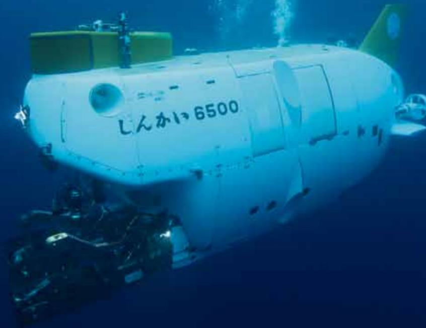
潜航開始直後の「しんかい6500」。深度6,500mまでは所要約2.5時間。3時間の調査後、再び約2.5時間かけて浮上する。 ©JAMSTEC
