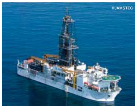
世界最高の掘削能力を持つ地球深部探査船「ちきゅう」。海底下7,000m、マントルや巨大地震発生帯の掘削が可能であり、生命の起源や地震発生の仕組み、海底資源の解明などのために活躍している。
