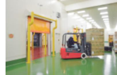
フォークリフトで製品を搬出する際に、フォークリフトの天井に取り付けられたICチップと無線受信部が連携し開口部の開閉を行う。
