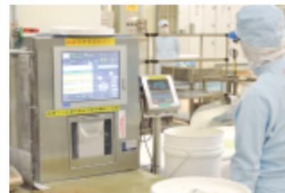
スーパー管理食の指示に従い、該当する原材料の計量をを行う。計量が済むとラベルが印刷され、そのラベルに印刷されたバーコードを読み取ることで後工程の処理が続けられる。
