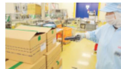
包装材が入っている段ボールのバーコードを読み取り、どれぐらいの量の包装材が使われたかなどもスーパー管理食が管理している。
