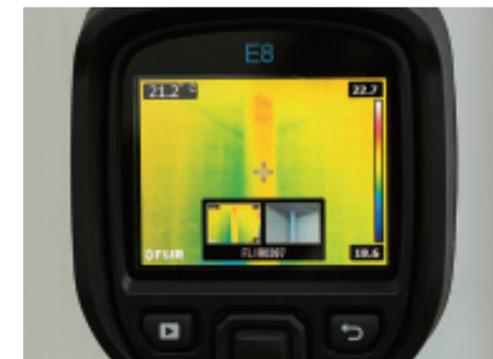
FLIRでは、サーモグラフィ画像と通常のデジタルカメラ画像を併置して確認、記録することが可能となっている。サーモグラフィ画像とデジタルカメラ画像を一緒に残すことで、後から確認する際に、どの部分のサーモグラフィ画像なのかがすぐに分かる。
