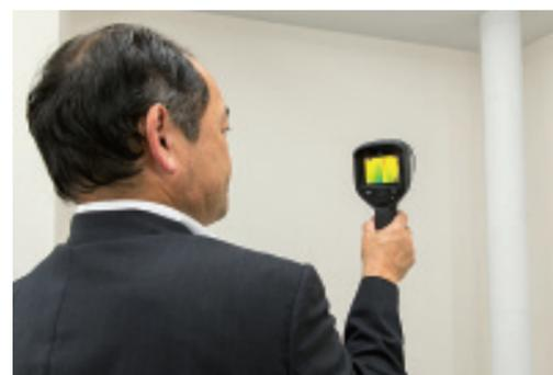
FLIRを用いてビル内の暖房用配管の温度状況を確認している。
