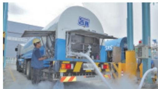
ウルサン工場で生産された産業用ガスは、パイプライン経由で顧客である各社の石油化学プラントに供給されるほか、超低温の液化にしてタンクローリーに充填(じゅうてん)し、お客さまに提供される。
