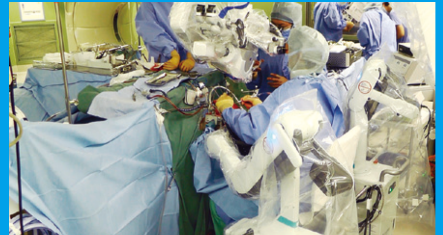
「iArmS」の臨床試験の様子。執刀医は左腕を「iArmS」で固定し、作業を行っていることが分かる。
