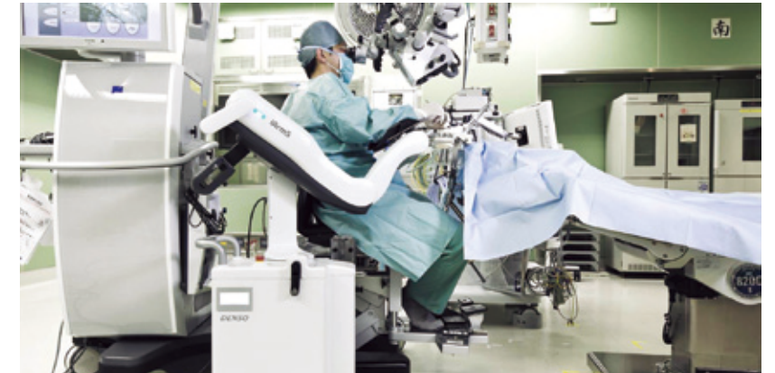
脳外科手術でのiArmS使用イメージ。術者は片手または両手をiArmSで固定し、顕微鏡をのぞきながら執刀する。
