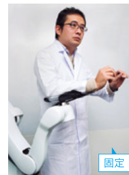
脳外科手術でのiArmS使用イメージ。術者は片手または両手をiArmSで固定し、顕微鏡をのぞきながら執刀する。
