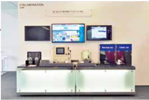
コラボレーションゾーンに設置されたリアルタイム微生物ディテクタでは水中の微生物を実際に検出するところを見ることができる(左)。高精度位置計測センサでは、フィルムの蛇行、幅、厚みを高精度に計測するデモンストレーションが行われる(右)。
