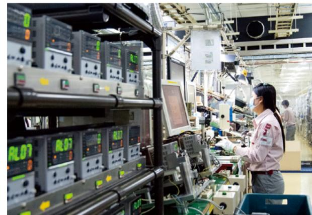
アズビルプロダクションタイランド株式会社の製造ライン。温度調節計、空調用コントローラなどの自動制御機器を製造している。
