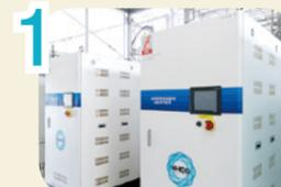
1 水電解セルで水を電気分解し、水素を取り出す。
