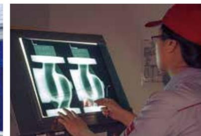
バルブの鋳物部分の鑄造欠陥を放射線透過試験により非破壊検査を行う。
