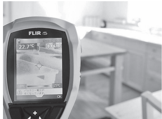
図8. サーモグラフィーでの温度分布確認
