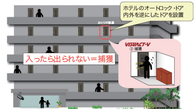
図2 おとり方式 — 捕獲のしくみ —
