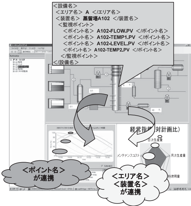
図7 データ連携のデータ構造および仕組み
