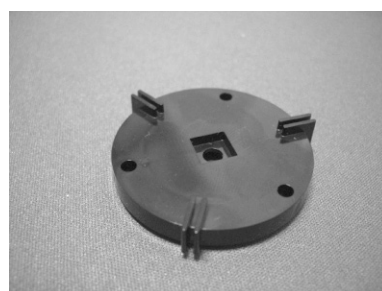
図7 投光LEDホルダーの完成品
