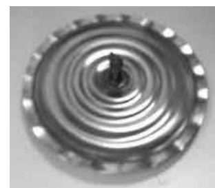
図3. 感温ダイアフラムの概観
