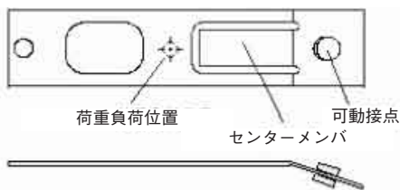
図4. 可動ばねの形状
