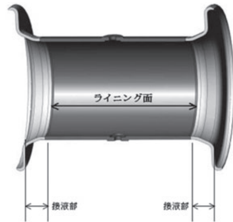
図7. 電池電磁の流体測定部
