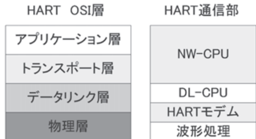
図 9. OSI 層と HART 通信部の構成
