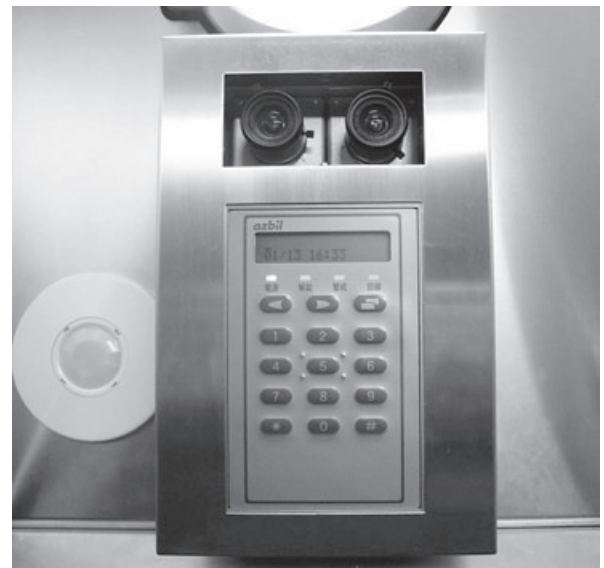
図5. プロトタイプユーザインターフェース部(ステレオカメラ, LCD, テンキー, 人感センサ付き照明)
