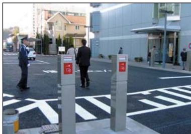
藤沢テクノセンターに設置された入出門専用リーダー
