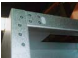
リベット締結による組み立て
