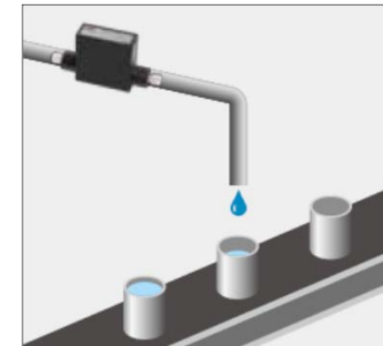
MEMSセンシング技術を活用した 熱式微小液体流量計F7M
