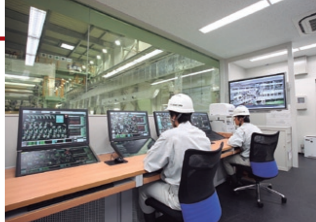
(图2)操作者可以在CCR里监控工厂的内部，同时用DCS检查控制过程。操作桌的几何形状是在考量了人体特征和可操作性的基础上设计出来的。
