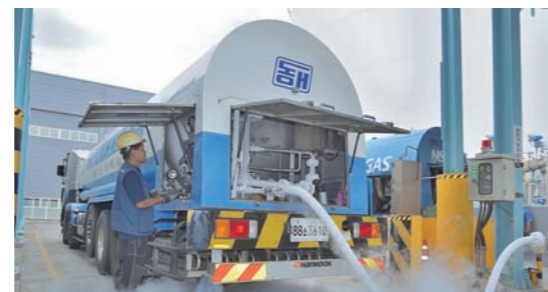
蔚山工厂生产的工业气体，除了通过管道输送至各顾客公司的石油化学工厂外，还可以将气体超低温液化，然后装到罐车中提供给顾客。
