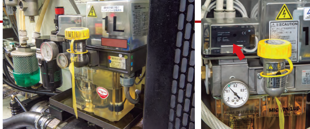
组装到机床中,对轴、轴承部分进行喷雾式润滑的喷雾润滑装置。
