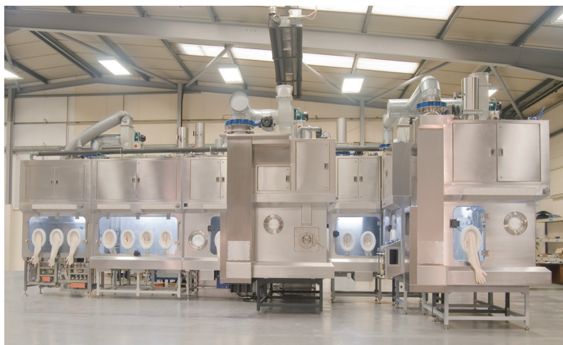
由Azbil Telstar, S.L.U.提供的隔离器。用于通过在隔离单元中进行有害、有毒处理时保护作业人员安全的装置。
