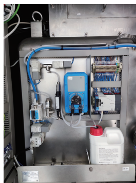
隔离器内搭载的Azbil Telstar, S.L.U.的ionHP+。在隔离器中的程序结束后,使用过氧化氢液体实施壳体内部的灭菌作业
