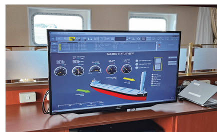
安装在船内的食堂、畅谈空间 Officer's Messroom 的大型监视器。显示由 Harmonas-DEO 控制的硬帆状态，访问该室的访客等也可以像操舵室一样确认硬帆的状态。
