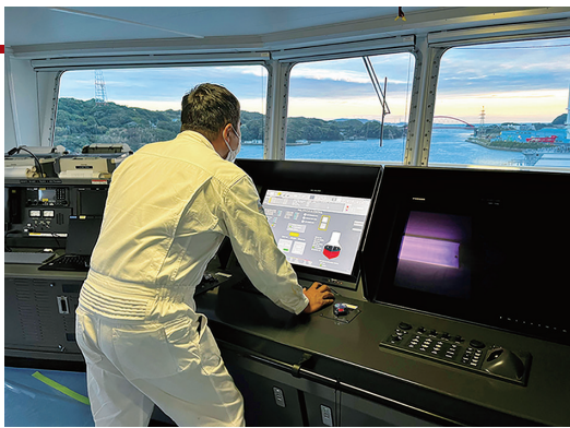
安装在操舵室内的IAS (Harmonas-DEO)。可根据风的状态实时确认自动控制的硬帆状态。紧急情况下也可由操作人员进行操作。
