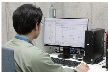
设置在仪表房的 InnovativeField Organizer 的监视器画面。不用奔赴现场即可在仪表房确认现场设备的运转状况。
