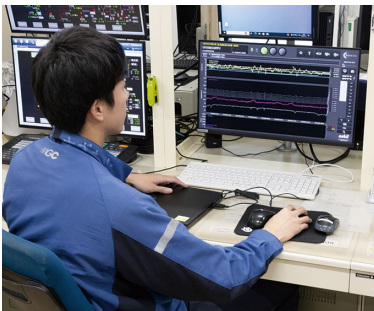
通过安装在中央控制室的 BiG EYES 监控供给泵的电流值
