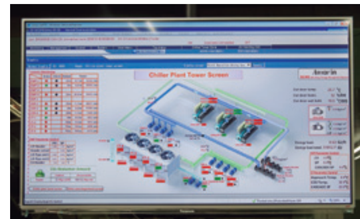
可以在热源系统图中同时确认多台冷水/冷却水泵的运转状况、旋转数、当前的消耗电量等。
