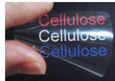
利用纤维素纳米纤维，可制成透明且氧气无法通过的坚固薄膜。
